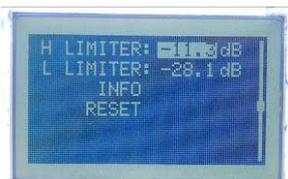
**Reset:** selezionando la voce *RESET* e premendo l'encoder, il DSP viene re-impostato ai valori di fabbrica.
