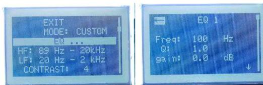
E' possibile intervenire su 5 bande di equalizzazione indipendenti impostandone la Frequenza di centro (*Freq:*), l'ampiezza dell'intervento di filtering (*Q:*) ed il guadagno in dB su tale frequenza (*gain:*).
